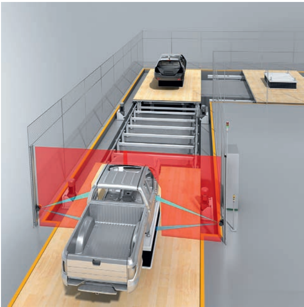
Afbeelding 1 Safe Portal - 'muting' op basis van contour.
