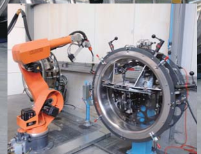
Lasrobot voor o.a. het lassen van ventilatorhuizen
