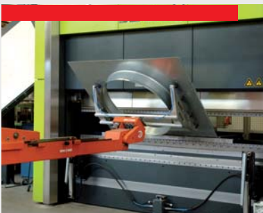
Kantbank met robot voor o.a. het geautomatiseerd kanten
